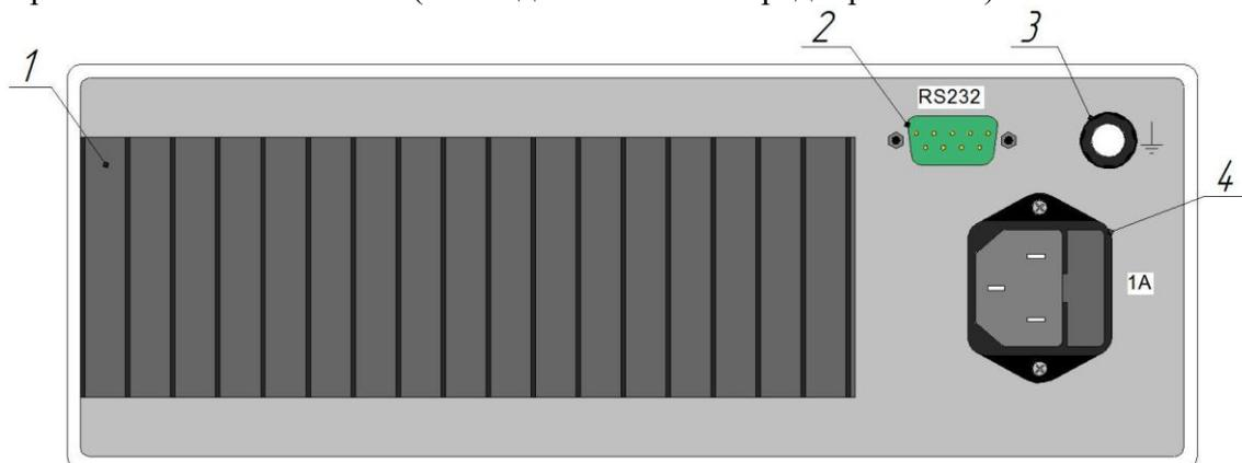
Рисунок 2 – Задняя панель омметра ТС-2.
