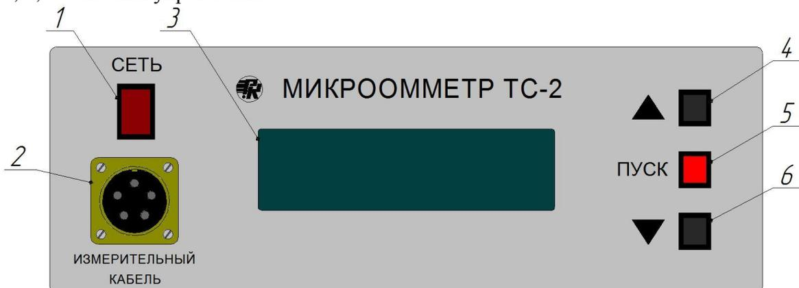
Рисунок 1 – Лицевая панель омметра ТС-2.
